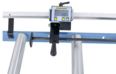
Längenmesssystem LS, nachrüstbar auf RB 4 / 7 / 10
