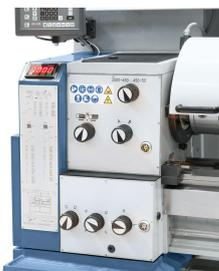
Leichtgängige Vorschub- und Drehzahlregelung am Getriebekopf, ruhiger Lauf durch gehärtete und geschliffene Zahnräder, im Ölbad laufend. Elektronisch, stufenlose Drehzahlregelung, leichtes Ablesen mittels Digitalanzeige.
