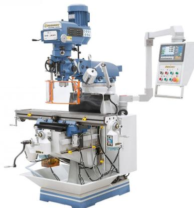
Durch die Vielzahl der Einstellmöglichkeiten des Fräskopfes der robusten und stabilen Mehrzweckfräsmaschine ist dieses Modell für Bohr- und Fräsarbeiten in der Einzelteilfertigung, Reparatur und im Ausbildungsbereich von leichten und mittelschweren Werkstücken optimal geeignet.
