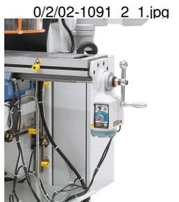
Standardmäßig mit stufenlosem Vorschub in x-, y- und z-Achse.
