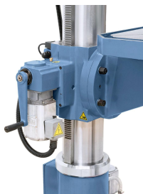
Deutliche Reduzierung der Nebenzeiten durch den motorischen Tischhub.
