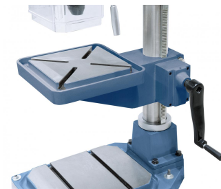
Geschliffener Arbeitstisch mit diagonal verlaufenden T-Nuten.
