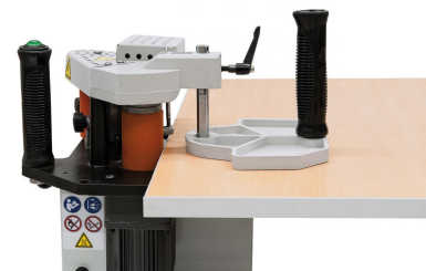
Höhenverstellbare Führungs- platte für Plattendicken von 10 - 55 mm
