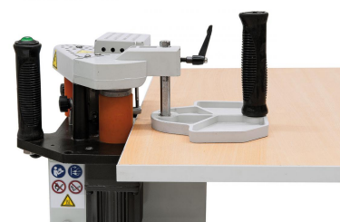
Höhenverstellbare Führungs- platte für Plattendicken von 10 - 55 mm
