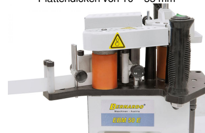
Das einstellbare Führungssystem erlaubt die Verwendung von Kantenstärken von 0,3 - 3,0 mm und Kantenhöhen von 10 - 55 mm
