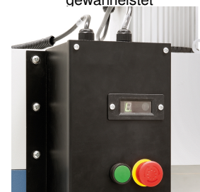
Der einstellbare Timer ermöglicht ein automatische Ein- bzw. Ausschalten der Absauganlage.
