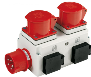
Einschaltautomatik ALV 10 / 1 M: Beim Ein- bzw. Ausschalten der Holzbearbeitungsmaschine wird die Absauganlage mit Zeit- verzögerung zu- bzw. abgeschaltet (Option).
