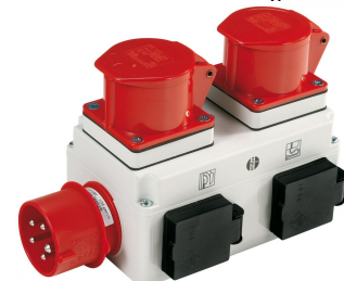
Einschaltautomatik ALV 10 / 1 M: Beim Ein- bzw. Ausschalten der Holzbearbeitungsmaschine wird die Absauganlage mit Zeit- verzögerung zu- bzw. abgeschaltet (Option).
