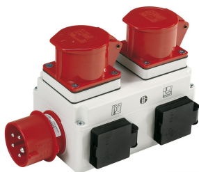
Einschaltautomatik ALV 10 / 1 M: Beim Ein- bzw. Ausschalten der Holzbearbeitungsmaschine wird der Radialventilator mit Zeitverzögerung zu- bzw. abgeschaltet (Option).
