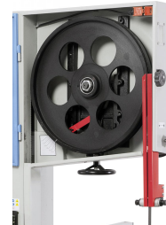
Dynamisch ausgewuchtete Laufräder aus Grauguss sorgen für einen ruhigen Lauf.
