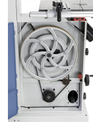
Die gewünschte Schnittgeschwindigkeit wird über einen Keilriemen am unteren Laufrad eingestellt.
