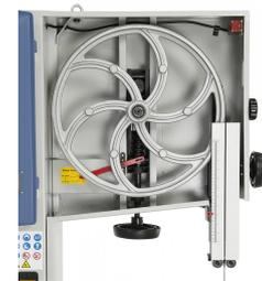
Die Einstellung der Blattspannung erfolgt mittels Handrad und wird über ein Diagramm am oberen Laufrad angezeigt.
