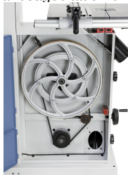
Die gewünschte Schnittgeschwindigkeit wird über einen Keilriemen am unteren Laufrad eingestellt.
