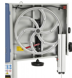
Die Einstellung der Blattspannung erfolgt mittels Handrad und wird über ein Diagramm am oberen Laufrad angezeigt.
