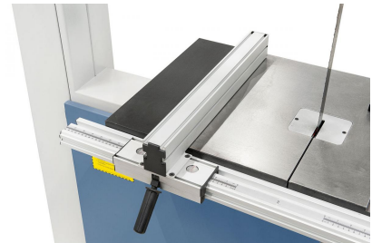
Leicht verstellbarer Aluminium- Anschlag mit Schnellklemmung, Ablesung der mm-Skala über eine Lupe.
