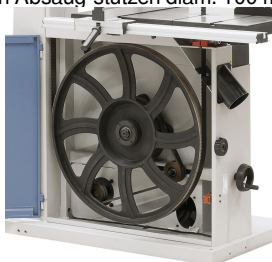
Das Antriebsrad mit Spezialgummi-bandage sorgt für einen ruhigen Lauf und erhöht die Lebensdauer des Sägebandes.
