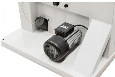
Durchzugsstarker Antriebsmotor auch bei längerem Betrieb, optimale Späneabfuhr durch den Absaugstutzen diam. 100 mm.
