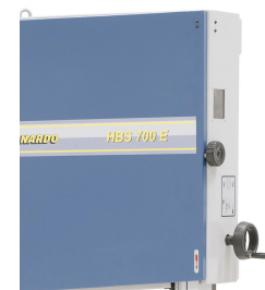
Sichtfenster für Bandlauf und Schnitthöhenverstellung an der Stirnseite
