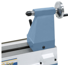
Robuster Reitstock mit MK 2-Aufnahme und Durchgangsbohrung zum Bearbeiten von langen Werkstücken.
