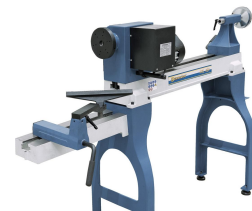
Die optional erhältliche Außendrehvorrichtung (Ø 720 mm) kann auch als Bettverlängerung (1200 mm) verwendet werden.
