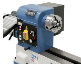
Spannfutter-Set Premium M 115, Stufenbacken
