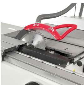
Der Sägeblattschutz mit integriertem Absaugstutzen ist am Spaltkeil befestigt. Serienmäßig mit Vorritzaggregat ausgestattet.
