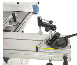
Eine in den Tisch eingearbeitete Skala ermöglicht ein exaktes Einstellen des Gehrungsanschlages.
