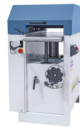
Stabiler Dickentisch mit Pinolenführung und Abstützung für exaktes Hobeln von Bretter, Leisten, Bohlen, ...
