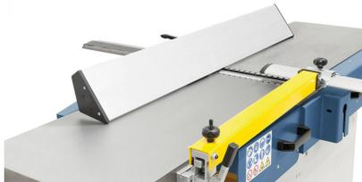
Durch die lange Auflagefläche erlaubt der aus Aluminium bestehende Abrichtanschlag eine Präzisionsbearbeitung von großen und schweren Werkstücken.
