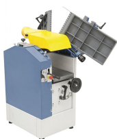
Einfaches und sekundenschnelles Umrüsten vom Abrichten zum Dickenhobeln durch aufklappbare Abrichttische
