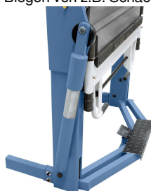
Serienmäßig mit Geißfuß-Segmenten, ideal zum Biegen von z.B. Schachteln.
