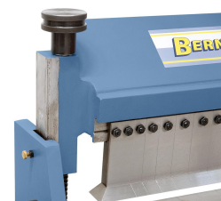
Segmentierte Ober-, Unter- und Biegewange für eine große Anzahl von Biegemöglichkeiten.
