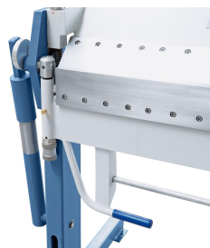
Ein Hilfszylinder erleichtert den Biegevorgang beim Abkanten.
