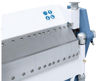
Segmentierte Ober- und Biegewange für eine große Anzahl von Biegemöglichkeiten.
