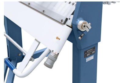
Die Einstellung der gewünschten Materialstärke erfolgt schnell und einfach mittels Einstellschrauben.
