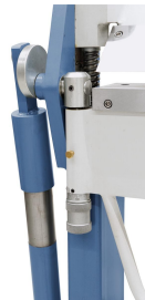
Ein Hilfszylinder erleichtert den Biegevorgang beim Abkanten.
