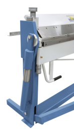
Die Einstellung der gewünschten Materialstärke erfolgt schnell und einfach mittels Einstellschrauben.
