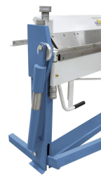
Die Einstellung der gewünschten Materialstärke erfolgt schnell und einfach mittels Einstellschrauben.
