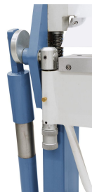
Ein Hilfszylinder erleichtert den Biegevorgang beim Abkanten.
