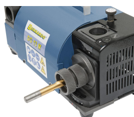
Schleifen des Spitzenwinkels
