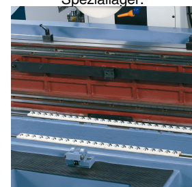
Die Tischlagerung erfolgt über eine wartungsfreie Linear-Kugelführung, der Antrieb erfolgt über einen Zahnriemen.
