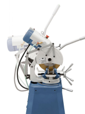
Schutzabdeckung öffnet automatisch beim Absenken des Getriebekopfes.
