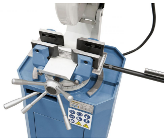
Zentrisch spannender Schraubstock mit längsverschiebbaren Spannbacken.
