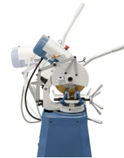
Schutzabdeckung öffnet automatisch beim Absenken des Getriebekopfes.
