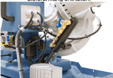
Leistungsstarke Kühlmittelpumpe im Lieferumfang enthalten.
