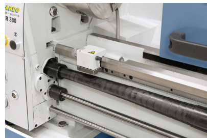
Mikrometerlängsansschlag und Rutschkupplung im Lieferumfang enthalten.
