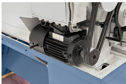
Leistungsstarker Antriebsmotor mit Magnetbremse nach CE-Norm.
