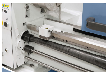
Mikrometerlängsanschlag und Rutschkupplung im Lieferumfang enthalten.
