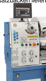
Leichtgängige Vorschub- und Drehzahlregelung am Getriebekopf, ruhiger Lauf durch gehärtete und geschliffene Zahnräder, im Ölbad laufend.
