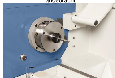
Das Spannzangenfutter ER 25 gewährleistet eine hohe Rundlaufgenauigkeit beim Spannen von Werkstücken, Spannungsbereich 1 – 16 mm
