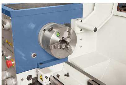
Vorteil des Bernardo-Backenfutters DK11-160 mm: Monoblock-, Grund-, Umkehr- und Aufsatzbacken lieferbar
