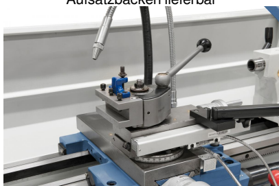
Zum rationellen Arbeiten ist die Maschine serienmäßig mit einem Schnellwechselstahlhalter ausgerüstet
