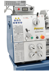
Einfache Bedienung, alle Schalt- und Bedienelemente übersichtlich am Getriebekopf angebracht
