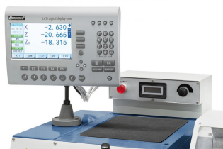
Elektronisch, stufenlose Drehzahlregelung, leichtes Ablesen mittels Digitalanzeige.
