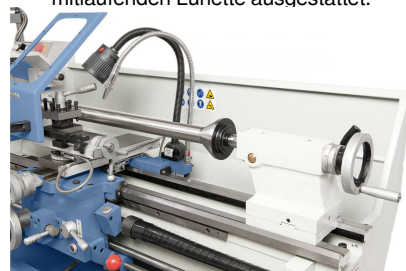
Zentrierkegel diam. 100 mm, ideal zum Spannen von Röhren und Hohlkörpern (Option)
