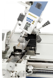
Durch den schwenkbaren Fräskopf ergeben sich eine Vielzahl von Bearbeitungsmöglichkeiten.
