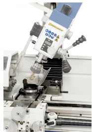
Durch den schwenkbaren Fräskopf ergeben sich eine Vielzahl von Bearbeitungsmöglichkeiten.
