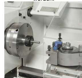
Optional lieferbar: Schnellwechselstahlhalter System Multifix und Spannzangenfutter ER 25
