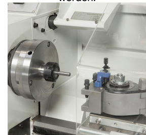
Optional lieferbar: Schnellwechselstahlhalter System Multifix und Spannzangenfutter ER 25
