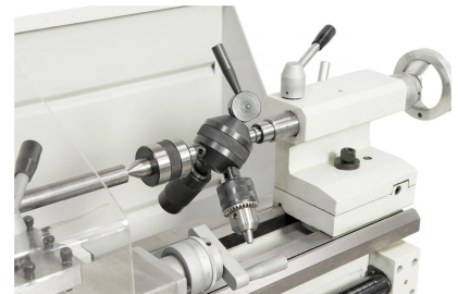
Zum wirtschaftlichen Arbeiten kann die Maschine mit einem Revolverkopf ausgestattet werden.
