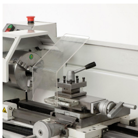
Zum rationellen Arbeiten ist die Maschine serienmäßig mit einem Schnellwechselstahlhalter ausgestattet.
