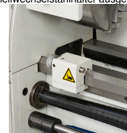
Serienmäßig mit Rutschkupplung und Mikrometerlängsanschlag ausgestattet
