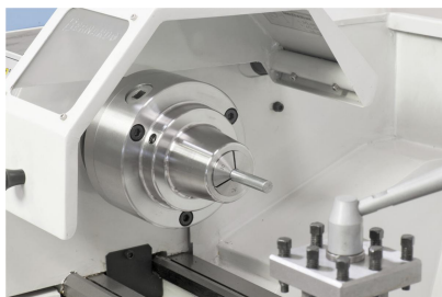
Optional lieferbar: Spannzangenfutter 5C, Spannbereich 3 - 26 mm
