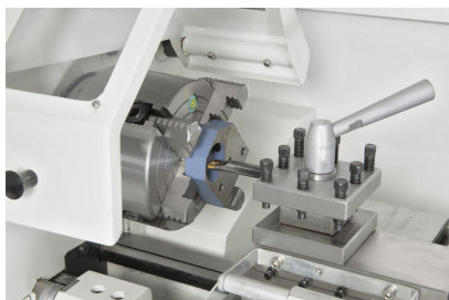
Plattscheibe 160 mm (Option) ideal zum Aufspannen von asymmetrischen Werkstücken
