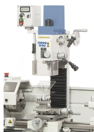
Erweiterter Einsatzbereich durch den nachrüstbaren Fräsaufsatz (Option)
