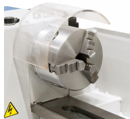
3-Backenfutter 100 mm mit Drehend Bohrbacken im Lieferumfang enthalten
