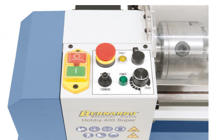
Die Spindeldrehzahl ist stufenlos einstellbar, serienmäßig mit Rechts-Linkslauf ausgestattet.
