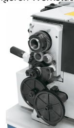
Wechselräder zum Gewindeschneiden im Lieferumfang enthalten
