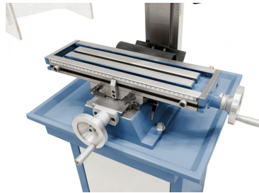
Präzise oberflächenbearbeiteter Kreuztisch mit 3 T-Nuten
