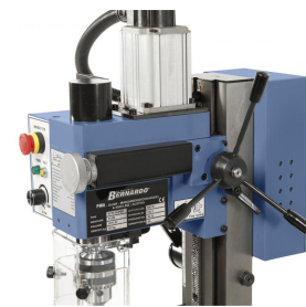
Großdimensionierter Sterngriff für leichte Pinolenzuste beim Bohren, Handrad für Feinzustellung beim Fräsen. llung
