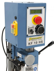
Elektronische, stufenlose Drehzahlregelung, leichtes Ablesen mittels Digitalanzeige.
