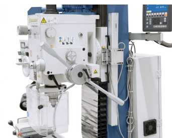
Der Pinolenvorschub kann wahlweise auf 0,10 / 0,18 oder 0,26 mm/U eingestellt werden
