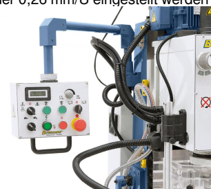
Einfache Vorwahl der Drehzahlstufe mittels Getriebewahlschalter, einstellen der gewünschten Drehzahl mittels Potentiometer.
