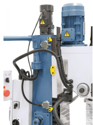
Fräskopfverstellung erfolgt unkompliziert mittels serienmäßigem Hubmotor.
