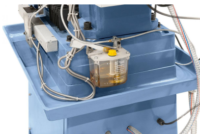
Serienmäßig mit Zentralschmierung für alle Führungsbahnen
