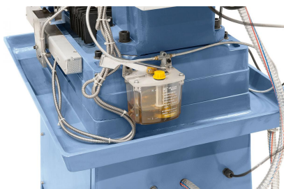
Serienmäßig mit Zentralschmierung für alle Führungsbahnen
