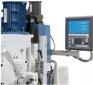
Durch die digitale Positionsanzeige in 3 Achsen wird eine Produktivitätssteigerung bis zu 50% erzielt.
