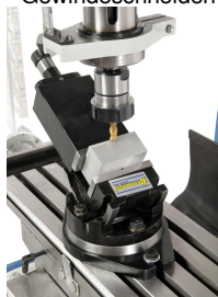
Fräsen mit 2-Achs-Schraubstock
