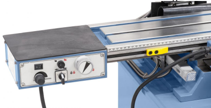
Für erhöhten Bedienkomfort serienmäßig mit stufenlos regelbarem Frästischvorschub FTV 6
