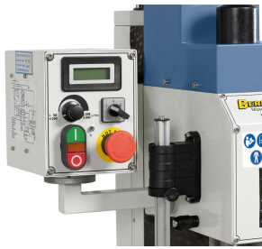
Serienmäßig mit digitaler Drehzahlanzeige und Rechts- Linkslaufeinrichtung
