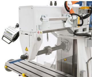
Serienmäßig mit Gegenlager und langem Fräsdorn für horizontale Fräsarbeiten
