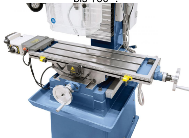
Großdimensionierter Kreuztisch mit T-Nuten und Kühlmittelrinne. Abbildung mit optionalem Frästischvorschub AL 450 D.
