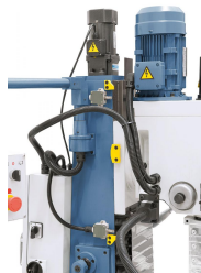
Fräskopfverstellung erfolgt unkompliziert mittels serienmäßigem Hubmotor
