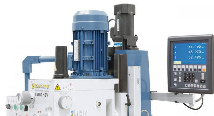
Die Digitalanzeige ES-12 V mit LCD- Display bietet vielfältige Funktionen wie z.B.: Lochkreisbearbeitung, Taschenfräsfunktion, ...
