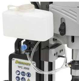
Automatische Innenschmierung, das Kühlmittel wird direkt an die Spitze des Kernbohrers geleitet
