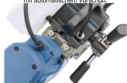
Zustellung der Pinole wahlweise manuell oder mit automatischem Vorschub.
